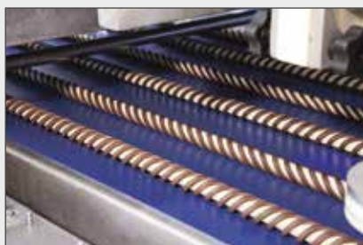
IT | Testata rotativa modello TSR6 per twist EN | Rotative head unit model TSR6 for twist ES | Cabezal rotativo modelo TSR6 para twist FR | Tête rotative modèle TSR6 pour twist
