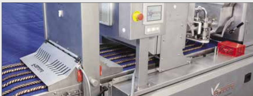
IT | Gruppo taglio ghigliottina/gruppo stampo EN | Cutting unit guillotine/mould unit ES | Unidad corte guillotina FR | Groupe de coupe à guillotine
